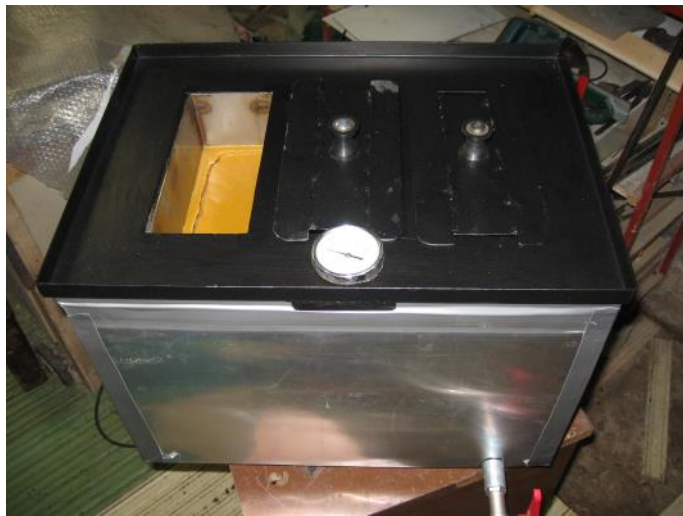
Caldaia auto costruita con tre vasche scaldate a bagno d'olio, termometro per il controllo temperatura calore olio
