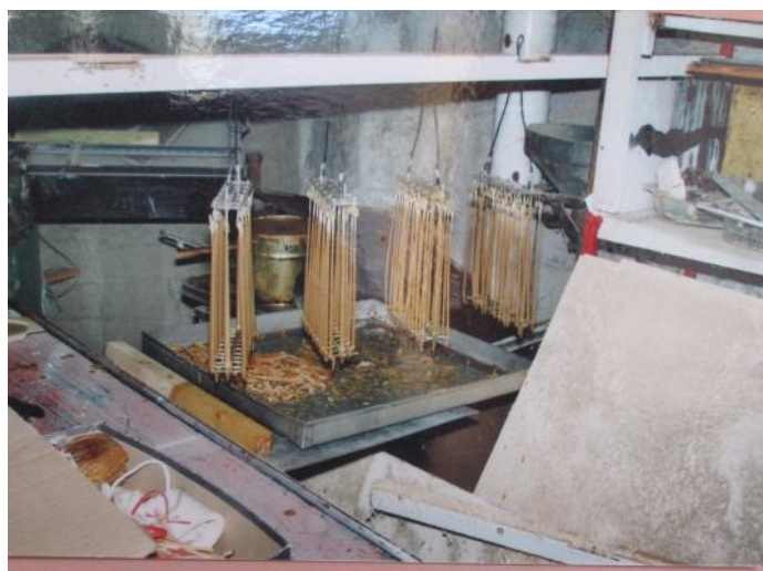
Prima sperimentazione, Cantina con stufa a legna con modelli di candele appese, sulla stufa latta con acqua
